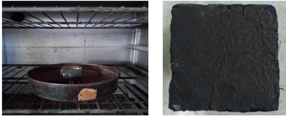
Gambar 5. Gambar Keretakan Pada Benda Uji
