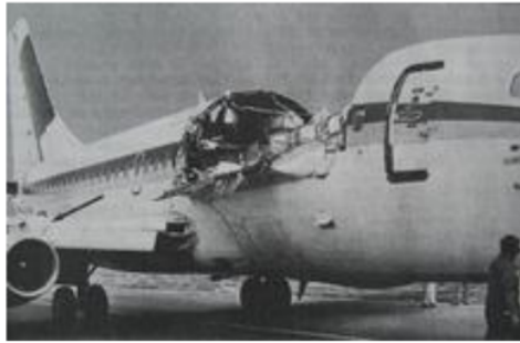
Gambar 1.1: Pesawat Boeing -737-200 milik Aloha Airline yang fuselage bagian atas terkoyak sepanjang 4 meter, setelah berhasil mendarat di bandara terdekat.
